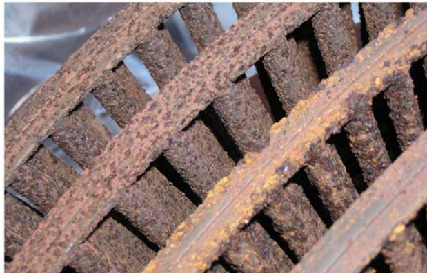
Extreme Korrosion nach fehlerhafter Konservierung einer Industrieturbine
