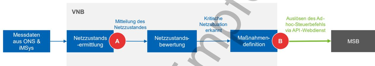
Bild 1 Prozessschritte des VNB zwischen Vorliegen des Ergebnisses der Netzzustandsermittlung und Auslösen des Steuerbefehls gegenüber dem MSB
