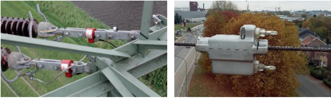
Abbildung 17: Monitoring der Abspannkraften (links) und der Seilschwingungen (rechts, [45])
