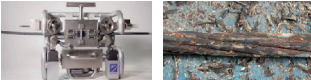
Abbildung 26: Mobiles System zur Messung des Querschnitts des Stahlkerns (links) und korrodierter Stahlkern, [64]
