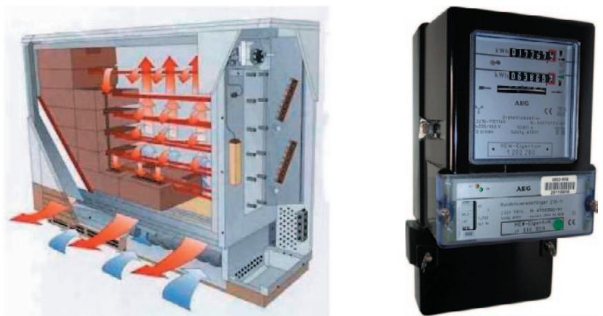
Abbildung 3-7: links: Nachtspeicher-Anlagenschema mit den wichtigsten Komponenten rechts: Zweitarif-Drehstromzähler mit Zählwerken für Nebentarif (oben) und Haupttarif (unten) sowie integriertem Rundsteuerempfänger
