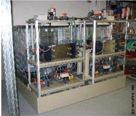
Abbildung 41: Links: Labormuster einer Vanadium-Redox-Batterie mit den Tanks für die positive und die negative Aktivmasse im Hintergrund und den Reaktionseinheiten und Pumpen in doppelter Ausführung im Vordergrund (Foto Fraunhofer ISE); Rechts: Konzeptstudie für eine Redox-Flow-Batterie im großtechnischen Maßstab für den Einsatz in Stromnetzen
