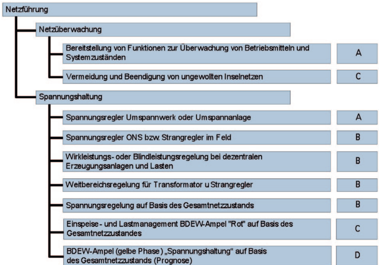
Abbildung 3-11: Beschreibung der Verfahren zur Netzüberwachung und Spannungshaltung
