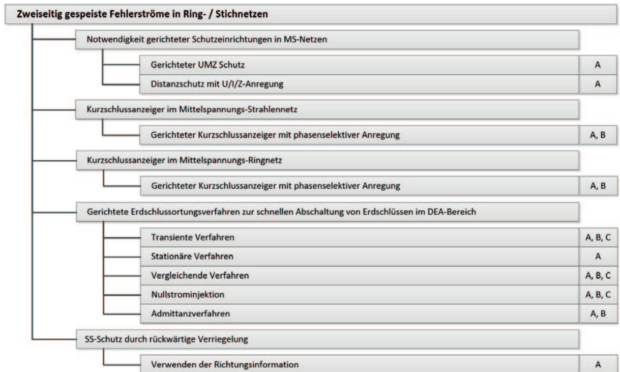
Abbildung 3-4: Zweiseitig gespeiste Fehlerströme in Ring-/Stichnetzen (Übersicht)
