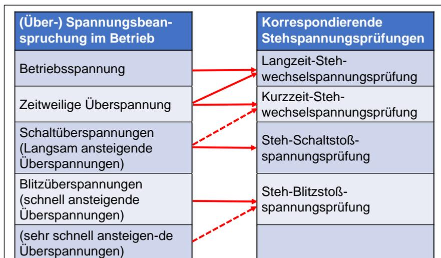
**Bild 11: Zusammenhang zwischen betrieblichen Spannungs- bzw. Überspannungsbeanspruchungen und prüftechnischem Nachweis**
